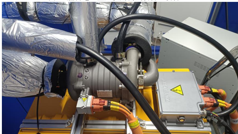
图 2 被测空压机（势加透博 XT-FCC400H 两级增压无油离心空压机）
